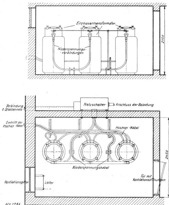
Fig. 9. Typische Transformatorstation im Innern eines Gebäudes.
