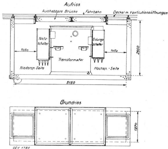
Fig. 8. Typische Transformatorgrube.
