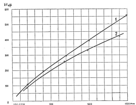
Fig. 18. Ölgefüllte Durchführungen für Freiluft. Vergleich der Überschlagsspannungen trocken.
