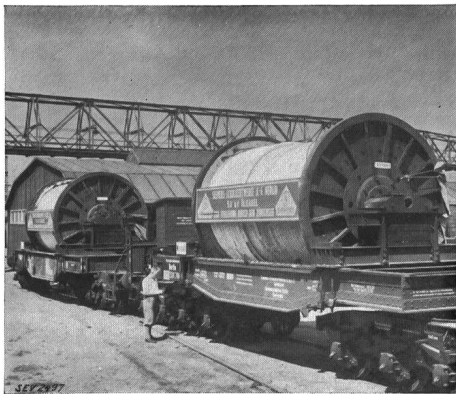
Fig. 4. 60-t-Spezialeisenbahnwagen für Kabeltransport.
