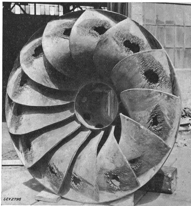
Fig. 14. Roue corrodée par la cavitation après 1 an de service. Turbine Francis: P_e = 1840 kW; n = 375 t/m. H_{moyen} = 19,5 m; n_s = 456 .
