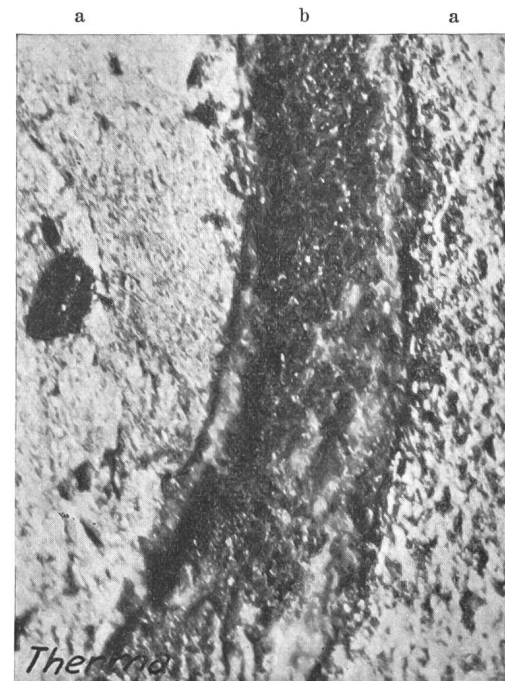
Fig. 16. Schnitt durch ein Stück abgeblätterte Zinkschicht. Vergrößerung ca. 100fach. a Einbettungsmetall. b Zinkschicht.
