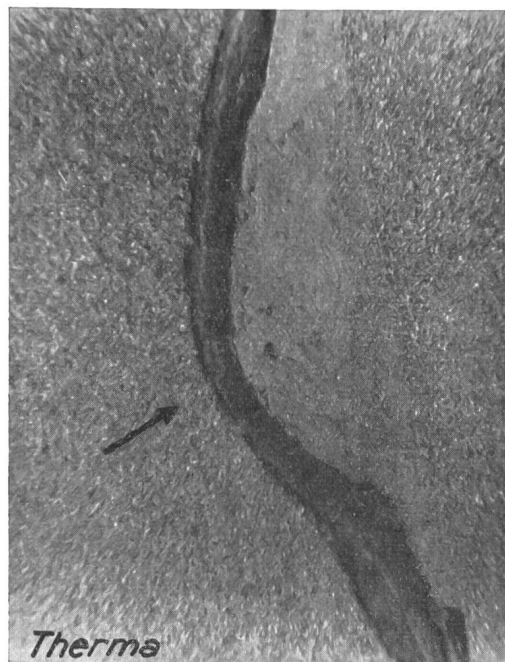
Fig. 15. Schnitt durch ein Stück abgeblätterte Zinkschicht. Vergrößerung ca. 20fach.
