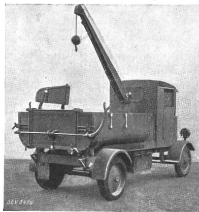
Fig. 14. Tracteur électrique à benne basculante, utilisé par le Service des Egoûts de la Ville de Lyon.
