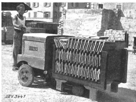
Fig. 7. Hubkarren beim Ziegeltransport, 1½ t.
