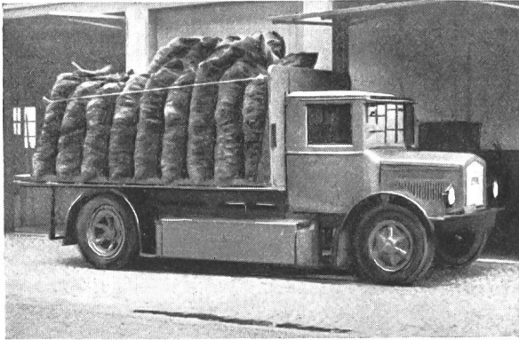
Fig. 11. Elektrolastwagen. Nutzlast 4000 kg. Aktionsradius 70 bis 80 km. Geschwindigkeit bis 30 km/h.
