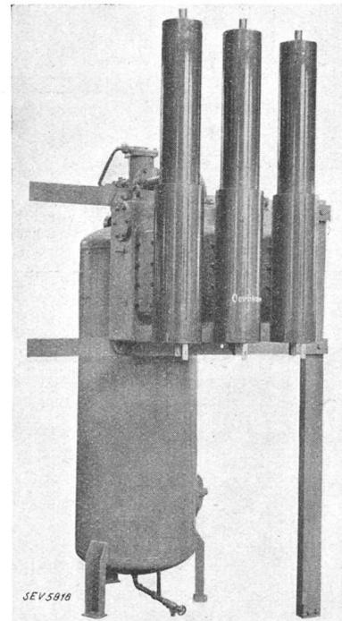
mechanischen Trennung des Stromkreises auch die nötige Blasluft in passender Zeit erzeugen können. Bei den Schaltern mit Fremderzeugung des Druckes dauert der Schaltvorgang vom Momente an, wo der Schalter den Ausschaltbefehl erhält, bis zur Löschung nur 0,05 bis 0,07 s. Wie hier diese Zeit durch die Erzeugung des Druckes und durch das später erläuterte Wandern des Lichtbogens beeinflusst wird, ist aus den bisherigen Ver-
