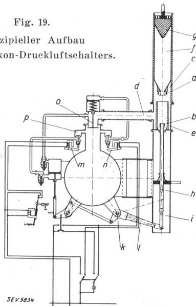
Aussenluft erfolgt hernach ohne störendes Geräusch durch den Schalldämpfer g. Da die Geschwindigkeit der Luft an den Lichtbogenansatzstellen im Gegensatz zur Einfachdüse beim Doppeldüsen-
