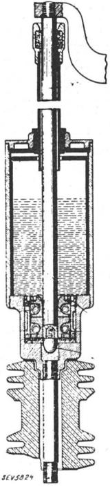
Während die amerikanische General Electric Co. in den Jahren 1898 und 1899 den Oelschalter mit offener Unterbrechung gebaut hatte, ging sie Ende 1899 auf Vorschlag von E. W. Rice zum eigentlichen Topfschalter (Fig. 4) über, der vorerst nur eine Umkehrung des Ferranti-Schalters der Fig. 3 war. Wir werden später auf die verschiedenen Entwicklungsformen dieses Topfschalters zurückkehren.
