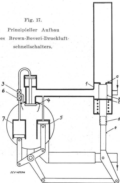
chungsdistanz vergrössern, da nach dem Abfluss der Blasluft die Strecke bei Atmosphärendruck der wiederkehrenden Spannung nicht standhalten würde. Die variable Geschwindigkeit im Antrieb des beweglichen Kontaktes wurde konstruktiv verschieden gelöst. Das rasche Beschleunigen und Abbremsen der bewegten Massen bietet aber immer gewisse Schwierigkeiten. Diese wurden beim Brown-Boveri-
