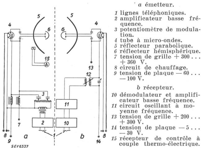
Fig. 21. Schéma d'une liaison par micro-ondes.
