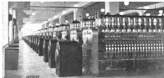
Fig. 8. Ringspinnmaschine, angetrieben durch Nebenschluss-Kommutatormotoren mit aufgebautem Spinnregler.
