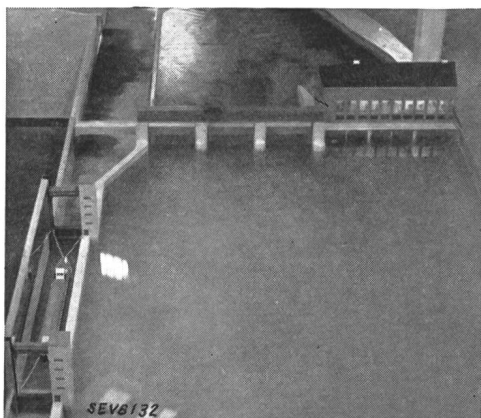
Fig. 6. Niederdruckwerk; links Schiffschleuse.
