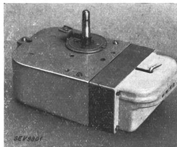
**Description:** Moteur de gramophone selon figure, pour le montage dans des appareils. Moteur monophasé à induit en court-circuit, démarrant automatiquement, avec régulateur et réducteur de vitesse pour régler la vitesse des disques à 78 tours/minute en moyenne. L'enroulement statorique est muni de prises intermédiaires et est commutable pour trois étendues de tension.
