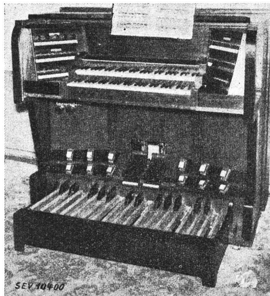
Fig. 20. Spieltisch einer grösseren Orgel mit Auswahlschaltung Das obere Manual ist vierstimmig. Das untere Manual und das Pedal sind einstimmig.
