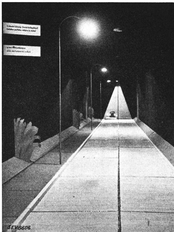
Fig. 11. Ideale Lösung: Strasse beleuchten! Beispiel: mit Natriumdampflampen.
