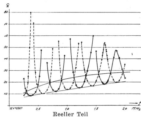
Damit wären alle gesuchten Grössen bestimmt. In Fig. 5 ist die Messung an einem speziellen Beispiel dargestellt. Es handelt sich um ein sogenanntes Verzögerungskabel (Isolation: Gummi), das zur Zeitverzögerung bei Spannungstossprüfungen mit dem Oszillographen verwendet wird<sup>4)</sup>.
