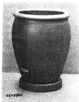
**Beschreibung:** Elektrischer Heizofen aus gebranntem Ton gemäss Abbildung. Widerstandsspiralen in Rillen eines zylindrischen Körpers aus gebranntem Ton eingelegt. Apparatestecker für den Anschluß der Zuleitung.
