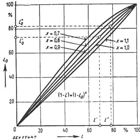
Fig. 4. Courbes d'étalonnage
