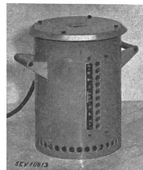
**Description:** Transformateur de soudure mobile, selon figure, monté dans un bâti en tôle; refroidissement à air. Ce transformateur possède deux enroulements séparés; le secondaire est muni de prises pour différentes puissances de soudure, allant de 15 à 150 A. Raccordement au réseau par un cordon à trois conducteurs, pour appareils mobiles.
