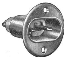
**Description:** Fiches d'appareils pour montage encastré, selon figure. Exécution pour 10 A. 380 V, selon norme SNV 24555. Socle en matière céramique, tiges et collet de protection en laiton nickelé. Ces fiches d'appareils sont également livrées avec couvercle de protection en matière isolante moulée.
