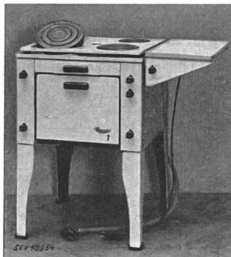
**Description:** Cuisinière électrique de ménage, selon figure, comprenant: 3 plaques de cuisson de 220, 180 et 145 mm de diamètre, un four et un chauffe-plats latéral. Plaques de cuisson constituées par des anneaux chauffants en acier inoxydable, disposés de façon à s'adapter au fond du récipient utilisé. Les plaques de cuisson sont munies de fiches normales. Un des corps de chauffe du four est monté à l'extérieur, l'autre à l'intérieur du four.
