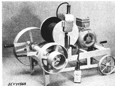
*Description:* Moteur triphasé à induit en court-circuit, de 4 CV, pour 380 V, selon figure; avec tambour pour enrouler le câble, interrupteur de protection et poulies pour courroies de transmission; le tout monté sur un bâti mobile. Le raccordement au réseau s'effectue au moyen de prises de courant industrielles pour 15 A, 500 V. Possibilité de changer le sens de rotation.
