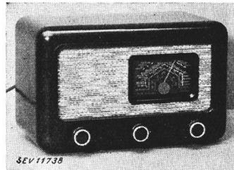
Description: Appareil de radiophonie, selon figure et schéma, pour les gammes d'ondes de 15,8 à 53 m et de 195 à 600 m ainsi que pour l'amplification gramophonique.
