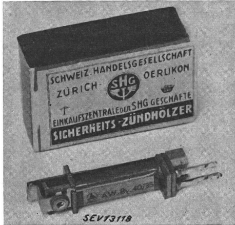
Fig. 5. Miniaturrelais des Impulswiederholers (Größenvergleich mit einer Streichholzschachtel)
