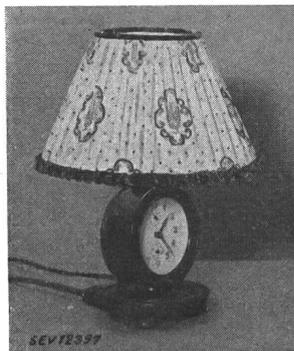
*Description:* Réveil avec interrupteur incorporé, combiné à une lampe de chevet, selon figure. La sonnerie provoque l'enclenchement de la lampe. Une prise de courant mobile, fixée dans la base — en bois — du réveil est branchée en parallèle à la lampe; il est ainsi possible d'enclencher d'autres appareils en même temps que celle-ci (par ex. un appareil de radio). Raccordement au réseau par un cordon
