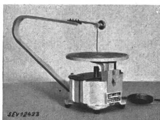
**Description:** Scie à découper pour travaux d'amateur, selon figure, comprenant une bobine de champ avec noyau en fer, montée dans la base de l'appareil. La lame de la scie est entraînée par une armature, constituée par une bande d'acier, qui vibre lorsque la bobine est alimentée
