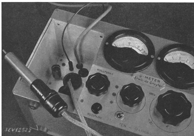
Fig. 13. Ansicht eines Kompensations-Röhrenvoltmeters mit eingebautem Netzanschlussgerät
