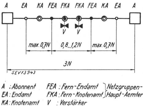
Fig. 9. Zulässige Leitungsdämpfungen im automatischen Fernbetrieb
