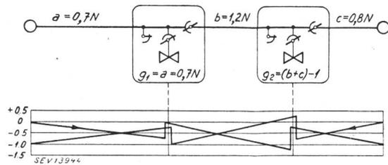
Fig. 10. Prinzip der Verstärkungsregulierung im automatischen Fernbetrieb
