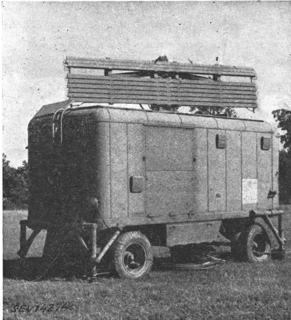
Fig. 4 Radaranlage mit Antennensystem zur Abtastung verschiedener Höhensektoren
