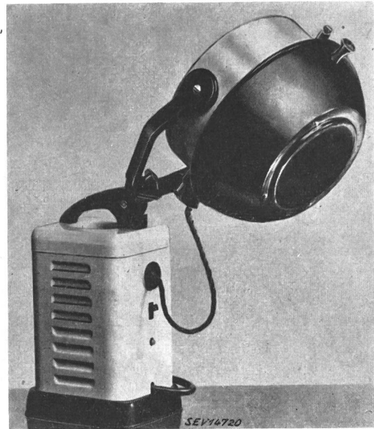
Fig. 1 Ultraviolettlampe für Materialuntersuchungen
