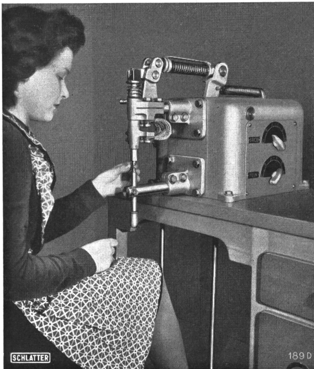
Fig. 3 Tisch-Punktschweissmaschine Schweissleistung 6 kVA, mit eingebautem automatischem Schweisszeitregler und 36stufiger Schweißstromregulierung
