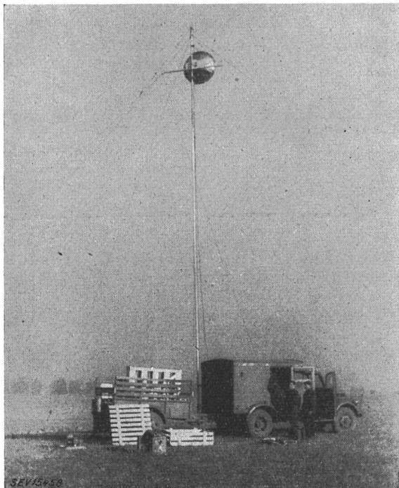
Fig. 16 Fahrbare Anlage für Ausbreitungsmessungen mit 200 MHz und 2000 MHz Die Richtstrahlantennen werden an einem demontierbaren Mast hochgezogen
