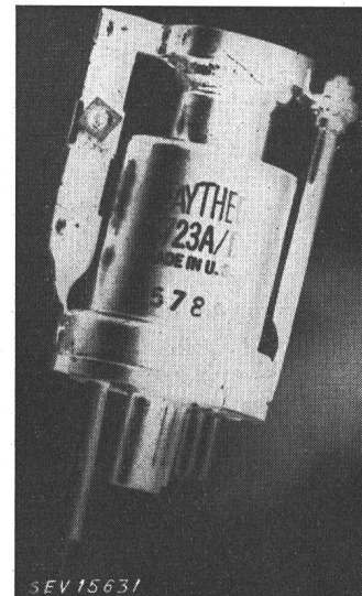
Fig. 2 Klystron elektronische Laufzeitöhre zur Erzeugung von Zentimeterwellen
