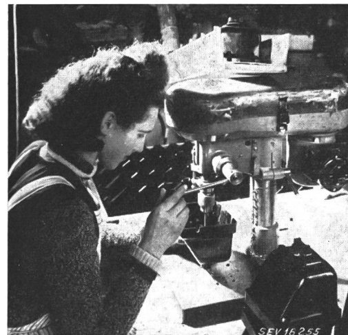
Fig. 3 Verputzen des fertig gepressten Gehäuses des Telephonapparates
