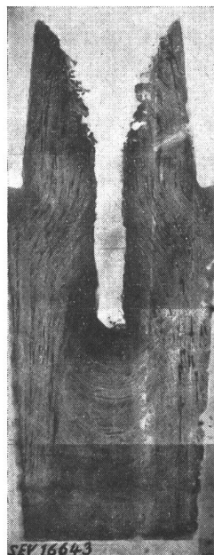
Fig. 6 Saugtrichter eines im Sand abgegossenen Stahlblockes (Baumannabdruck)
