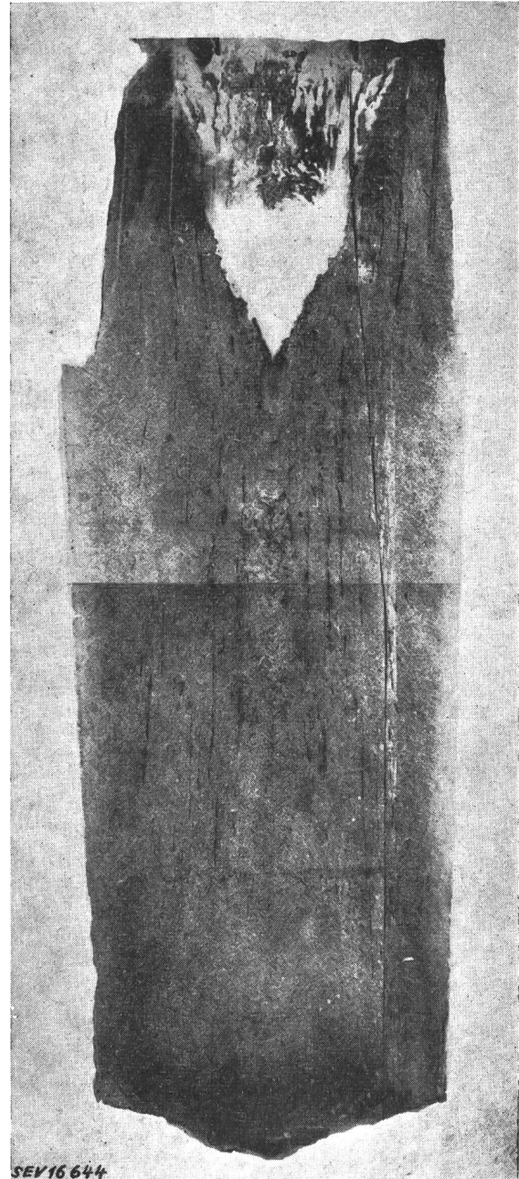
Fig. 7 Im Guss eingeschlossene «Seigerungen» (Baumannabdruck)
