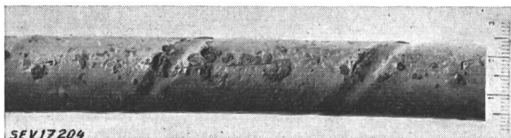
Fig. 4 Câble corrodé par du ciment
