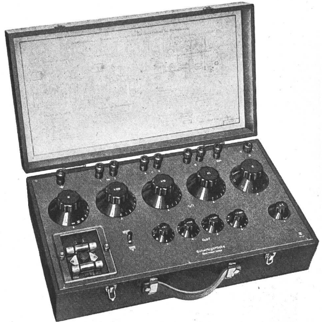
Fig. 3 Hochspannungs-Messbrücke nach Schering
