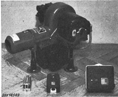
du point médian de l'enroulement à haute tension du transformateur d'allumage. Commande par appareil automatique de couplage, thermostat de chaudière et thermostat d'ambiance «Minneapolis Honeywell».
