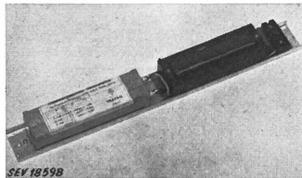
0,01 µF, en parallèle avec la lampe. Plaque de base en tôle d'aluminium. Bornes sur socle en matière isolante moulée. Appareil d'exécution étroite, sans couvercle, pour montage dans le luminaire.
