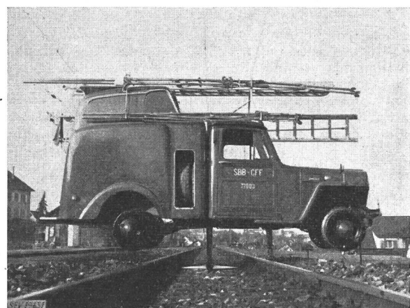
Fig. 3 Hilfsfahrzeug mit Schienenrädern in Wendestellung
