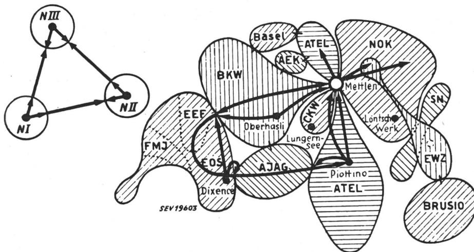
dreier im Dreieck angeordneter Netze angeführt werden. Fig. 12 zeigt links oben schematisch die drei Netze I, II und III mit den drei Verbindungsleitungen. Um eindeutige Verhältnisse bei den Übergabeleistungen zu erhalten, müssen die drei
