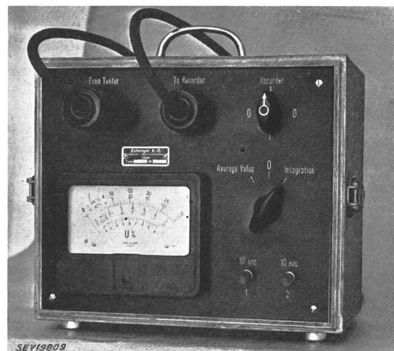
Fig. 9 Integrator zur Bestimmung der mittleren Ungleichmässigkeit eines Querschnittsverlaufes
