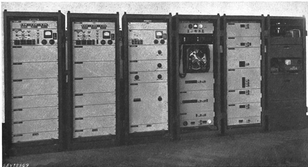
Fig. 8 Transportable Richtstrahl-Apparatur mit Trägerfrequenz-Mehrkanalzusatz für eine amerikanische Ölgesellschaft Schrank 1...3 Trägerfrequenz-Mehrkanal-Apparatur; Schrank 4 Richtstrahl-Empfangsgerät; Schrank 5 Richtstrahl-Sende- gerät; Schrank 6 Zubehörmaterial
