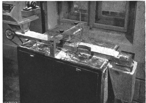
Fig. 23 Versuchsanlage zur Mehlsterilisation mit Hochfrequenz-Energie im Durchlaufverfahren
