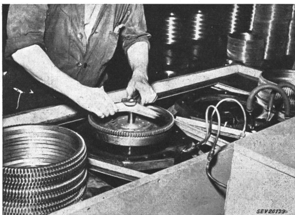
Fig. 19 Arbeitstisch für Aufschrauben und Härten des Zahnkranzes
