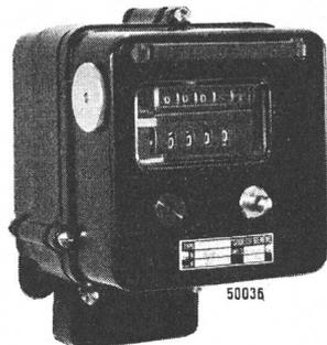
nen und für Spul- und Wickelmaschinen wird vielfach ein *Vorwahlzähler* (Fig. 1) benützt, der nach Erreichen einer im voraus eingestellten Zahl einen Stromkreis schliesst oder öffnet. Um die Auslösung unabhängig von Vor- und Rückwärtsbewegungen genau im gewünschten Moment zu verwirklichen, wurde der Impulsfernzähler für Vorwahl für Vor- und Rückwärts-Zählung geschaffen.
