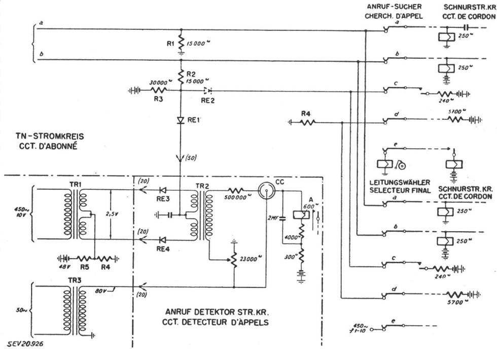
présence d'une batterie à travers une résistance faible au fil  $c$ , ce qui arrête l'opération du détecteur d'appel. En même temps, une batterie est connectée vers le fil « $d$ », marquant la ligne occupée. Lorsqu'un sélecteur final engage la ligne, une batterie identique est appliquée au fil  $c$  à travers une résistance
