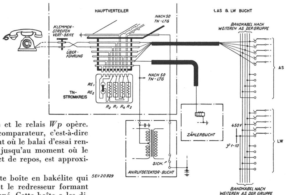
trôle, le tube  $SV_2$  s'allume et le relais  $Wp$  opère. Le temps d'opération du comparateur, c'est-à-dire le temps à partir du moment où le balai d'essai rencontre le potentiel voulu, jusqu'au moment où le relais  $Wp$  ouvre son contact de repos, est approximativement de 2 ms.
