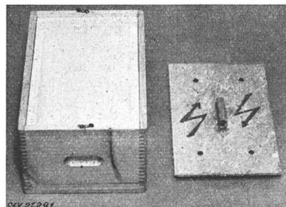
duction de tubes isolants. Des cordons d'amiante sont enrobés dans le plâtre. Dimensions intérieures: 320 × 205 × 155 mm. Epaisseur des parois: env. 18 mm. Dimensions extérieures: 385 × 260 × 185 mm.
