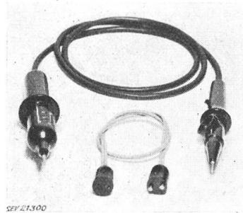
voltmètre et wattmètre avec échelles pour max. 250 V ~ et 85 W ~, l'autre touche d'un contact à pression, d'une douille pour starter à effluve et d'un contact d'interruption. Celui-ci est actionné lors de la mise en place d'un starter ou du cordon de prolongement, qui sert à contrôler si les cathodes de la lampe sont intactes ou non.
