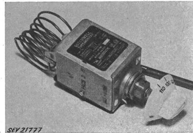
en stéatite, dans un boîtier en tôle d'acier inoxydable. Sonde de température en cuivre nu. Températures de couplage réglables à l'aide d'un bouton rotatif en matière isolante moulée. Bornes de raccordement sur socle en matière isolante moulée.
