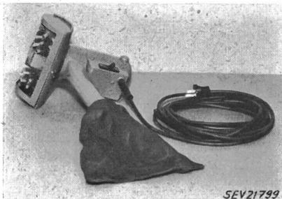
conducteurs isolés au caoutchouc, avec fiche 2 P pour 10 A, 50 V, introduit par un tube en caoutchouc et fixé à l'appareil. Le raccordement au réseau du moteur bobiné pour 24 V s'opère par un transformateur de protection pour locaux mouillés.
