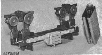
de roulement aux supports de ces galets et, de là, par des torons en cuivre, à la traverse en fer à laquelle le moteur est fixé. Ce chariot monorail est destiné aux ateliers et aux entrepôts couverts. La puissance du moteur peut atteindre jusqu'à 2 ch.
