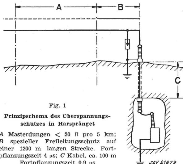
Prinzipschema des Überspannungsschutzes in Harsprånget
