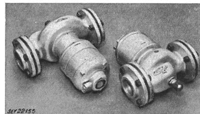
fié par eau. Induit séparé du fer du stator par un manchon étanche en métal. Enroulement en cuivre. Enroulement auxiliaire du moteur n° 2 raccordé en permanence en série avec un condensateur de 1  $\mu$ F pour 380 V ~. Bornes de raccordement et vis de mise à la terre protégées par un couvercle vissé. Tubulure de raccordement pour tube isolant armé d'acier.
