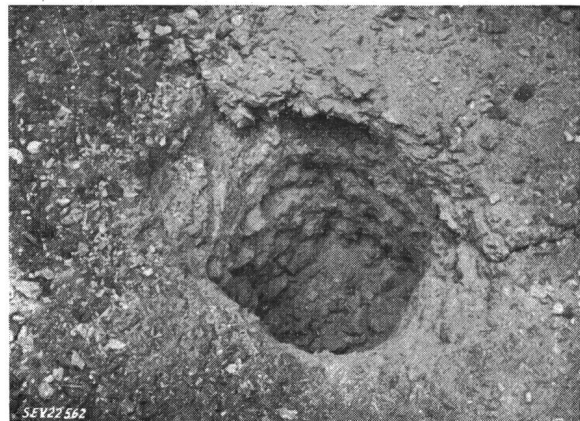
Fig. 12 Versuch Nr. 10 Aufnahme nach der zweiten Sprengung im oberen Teil: Steinbruchabraum im unteren Teil: Kalkfelsen
