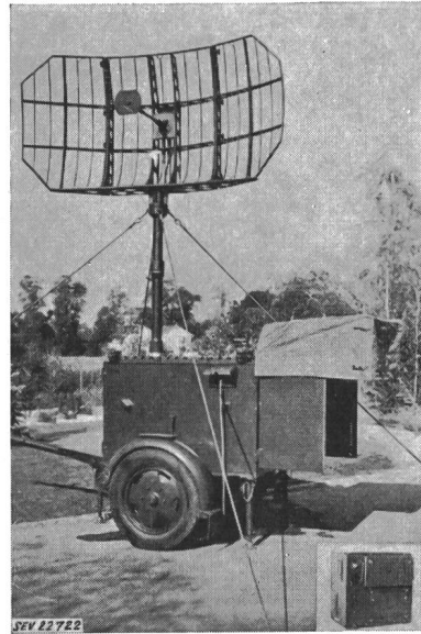
Fig. 22 IFF, Freund-Feind-Erkennungsgerät Reichweite ca. 60 km (Schweiz)
