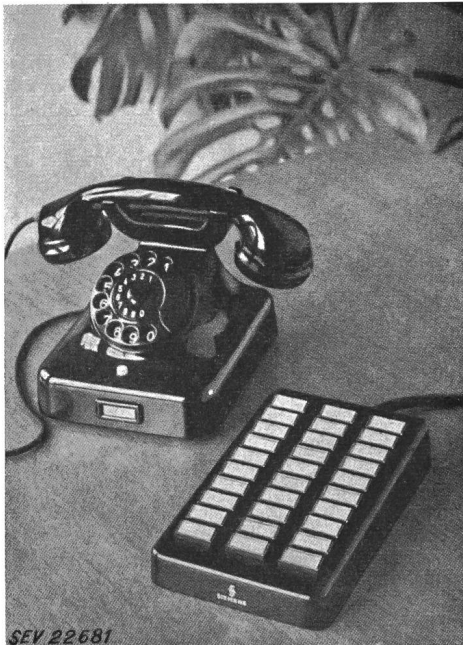
Fig. 1 Namentaster Tastenplatte mit 30 Platten
