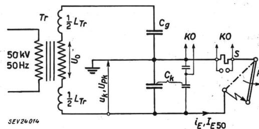
Fig. 14 Erdschluss am Modell-Netz
